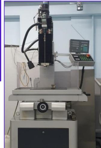
Электроэрозионный прошивной станок для получения малых отверстий Д703 (супердрель)
