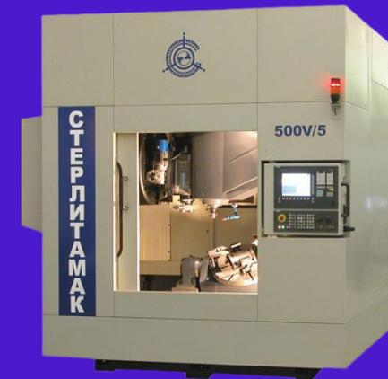
Предназначен для выполнения сверлильно-фрезерно-расточных работ для обработки корпусных деталей и деталей сложной формы.
