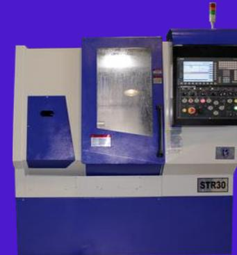
Предназначен для высокопроизводительной токарной обработки деталей типа «фланец», «втулка», «ниппель», «штуцер» и т.д. из различных конструктивных материалов в условиях единичного и мелкосерийного производства.
