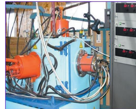
Установка HVB-6,6-И1 для осаждения функциональных покрытий, модифицированная собственными силами
